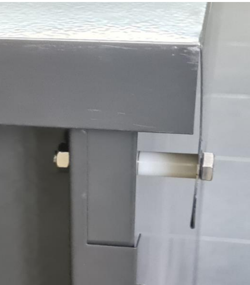
17. Secure bolt using nut
